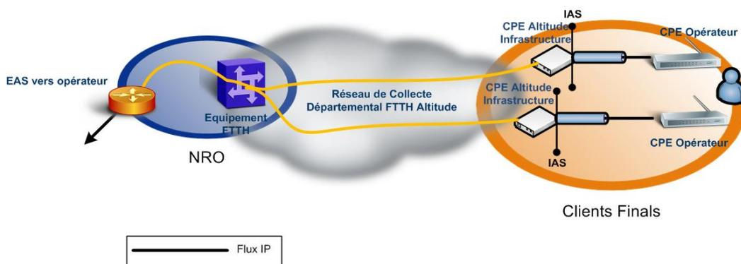
Il est nécessaire que l'équipement de l'Opérateur Commercial (CPE opérateur) sur le site utilisateur obtienne son adresse IP grâce au protocole « DHCP ».
