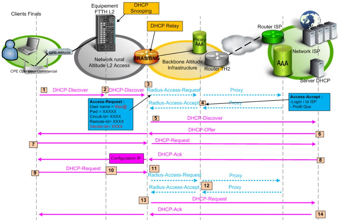
Toutes requêtes DHCP du CPE Opérateur Commercial fait suite à une authentification Radius (Radius Access-Request et Access-Accept) comme décrit dans le schéma ci-dessus.
