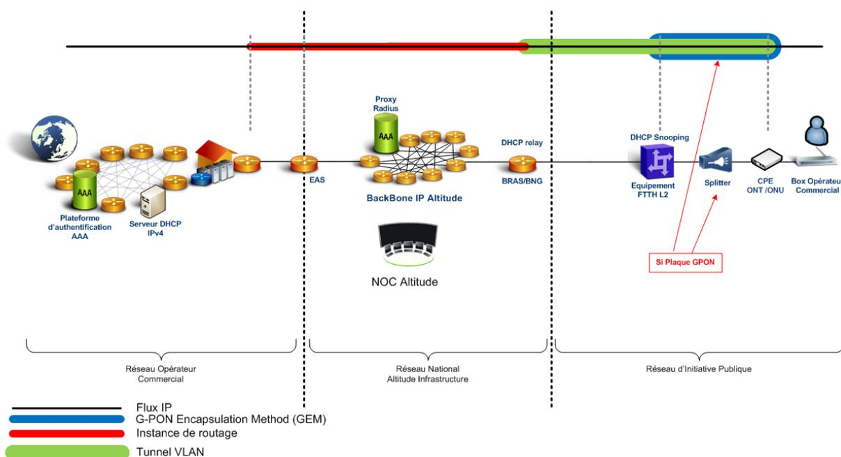
**Remarque :** Dans le cas d'une architecture P2P (point à point), le splitter optique n'existe plus et l'ONT/ONU est remplacé par un CPE Altitude Infrastructure.
